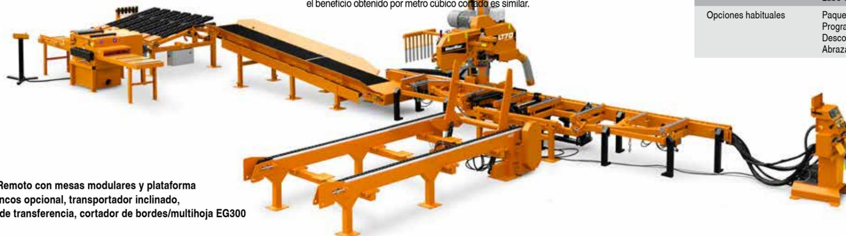
LT70 Remoto con mesas modulares y plataforma de troncos opcional, transportador inclinado, mesa de transferencia, cortador de bordes/multihoja EG300
